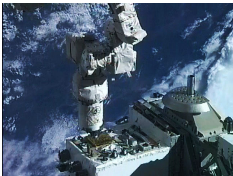
Рис. 10. Манипулятор «Dextre» осуществляет обслуживание модуля RPM
