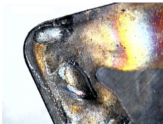
Рис. 3. Лункообразование на режущей пластине
