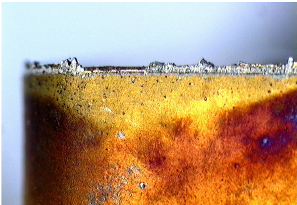
Рис. 4. Наросты на режущей кромке
