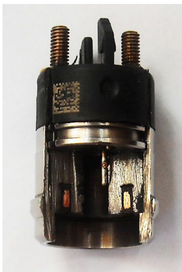
Рис. 4. Разрез катушки электромагнита
