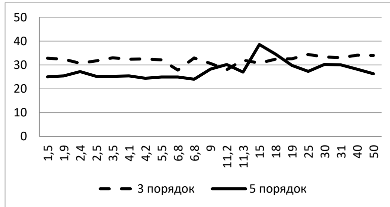
Рис. 5. График интермодуляционных продуктов 3 и 5 порядка при напряжении питания 24В
