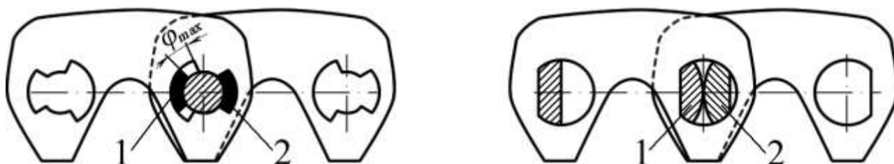
Рис. 6.4. Конструкция шарниров зубчатой цепи
