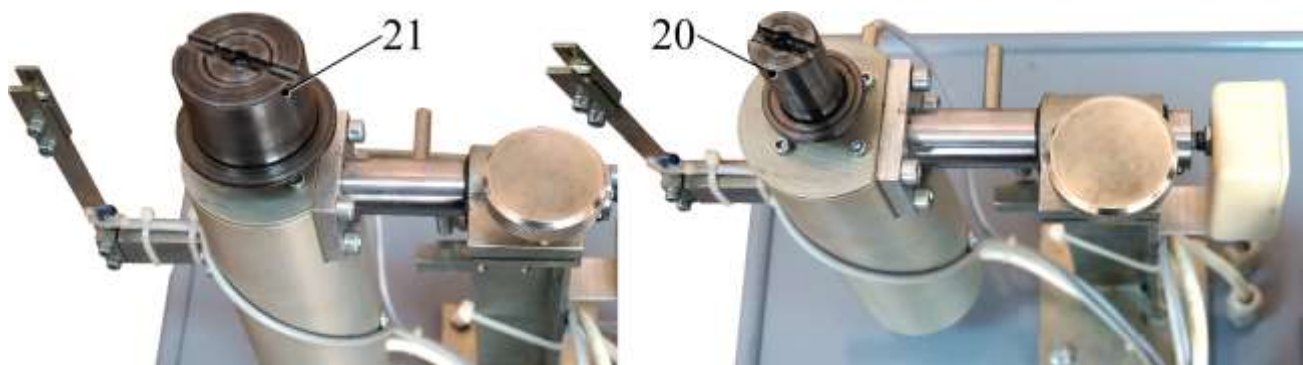
Рис. 5.5. Приводной вал (справа) и переходная втулка (слева)
