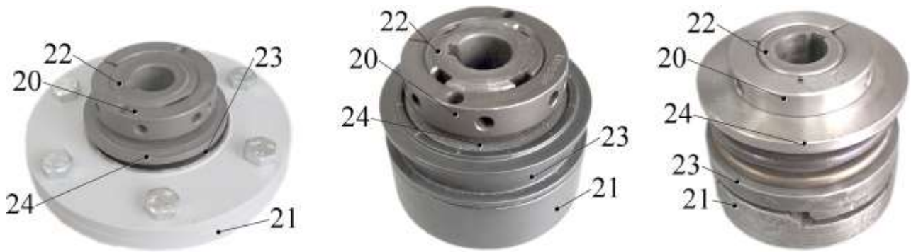
Рис. 7.23. Испытуемые муфты: фрикционная (слева), шариковая (в центре), кулачковая (справа)
