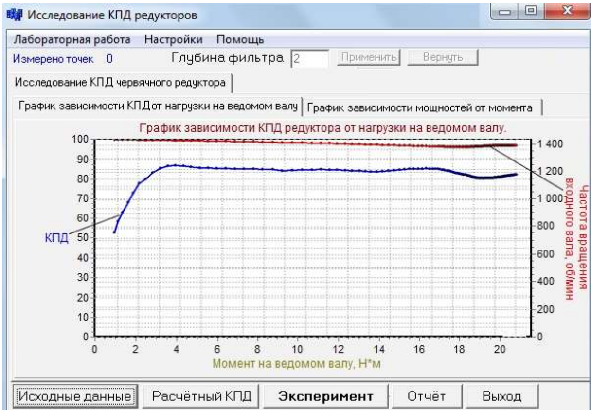
Рис. 4.9. Результаты эксперимента в виде графиков КПД редуктора от нагрузки с применением фильтра
