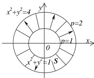
1. Уравнения границ  $x^2 + y^2 = 1$  и  $x^2 + y^2 = 4$ . В полярной системе координат:  $(\rho \cos \varphi)^2 + (\rho \sin \varphi)^2 = 1$  и  $(\rho \cos \varphi)^2 + (\rho \sin \varphi)^2 = 4$ , или  $\rho = 1$  и  $\rho = 2$ ;  $0 \leq \varphi \leq 2\pi$
