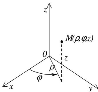
Цилиндрические координаты точки  $M$ :  $\rho, \varphi, z$ .  $0 < \rho \leq +\infty$ ;  $-\pi < \varphi < \pi$  (или  $0 \leq \varphi < 2\pi$ ),  $-\infty \leq z \leq +\infty$ . Декартовы и цилиндрические координаты связаны соотношениями:
