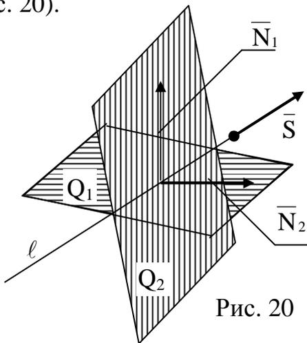
$$\begin{cases} A_1x + B_1y + C_1z + D_1 = 0 & (Q_1) \\ A_2x + B_2y + C_2z + D_2 = 0 & (Q_2) \end{cases} \quad (21)$$
