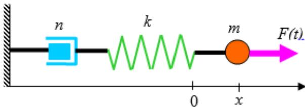
Рис. 1. Механический амортизатор
