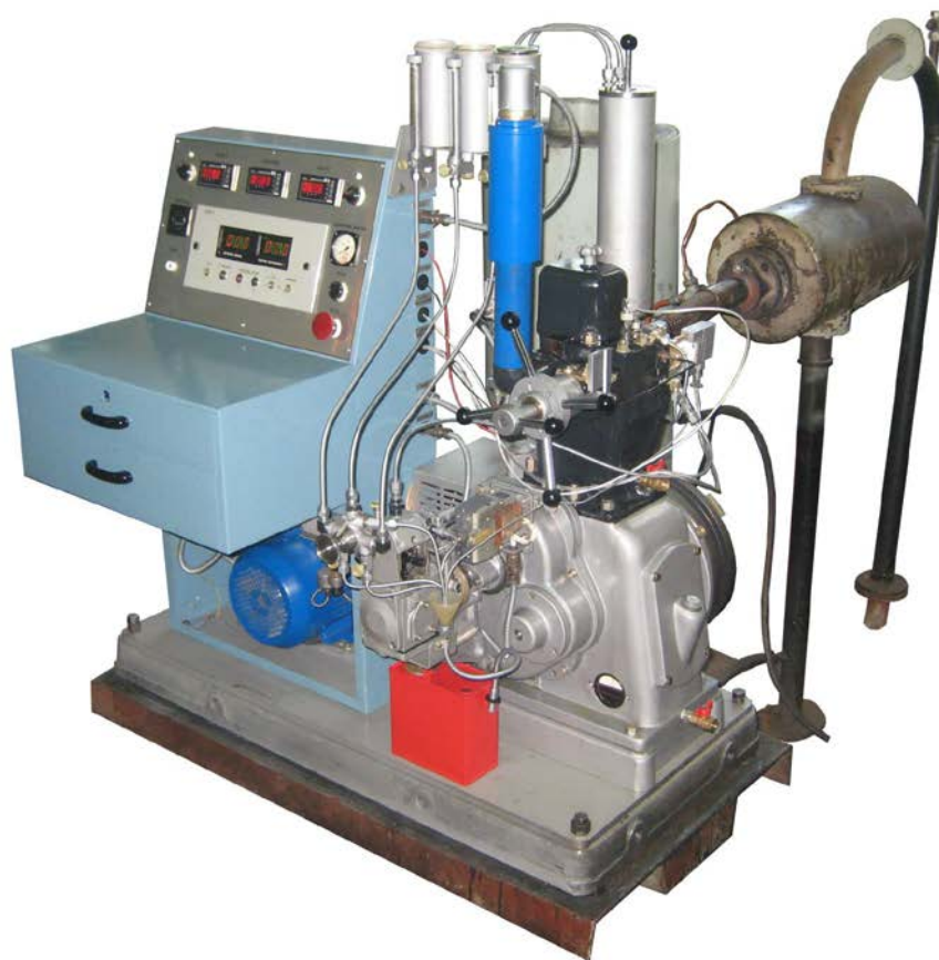
Рис. 3.2. Установка ИДТ-90 для определения цетановых чисел ДТ
