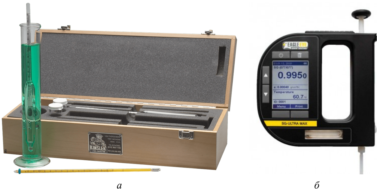
Рис. 3.1. Ареометры для измерения плотности бензина: а – механический; б – цифровой
