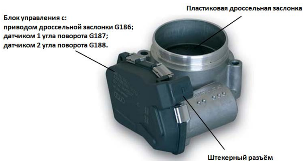
Рис. 40. Устройство модуля дроссельной заслонки
