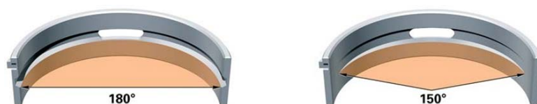
Рис. 24. Изменение угла серповидной канавки верхнего коренного вкладыша
