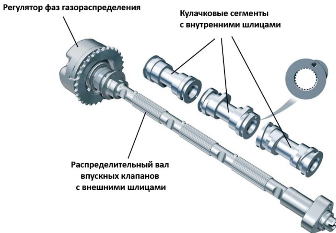
Рис. 13. Устройство распределительного вала
