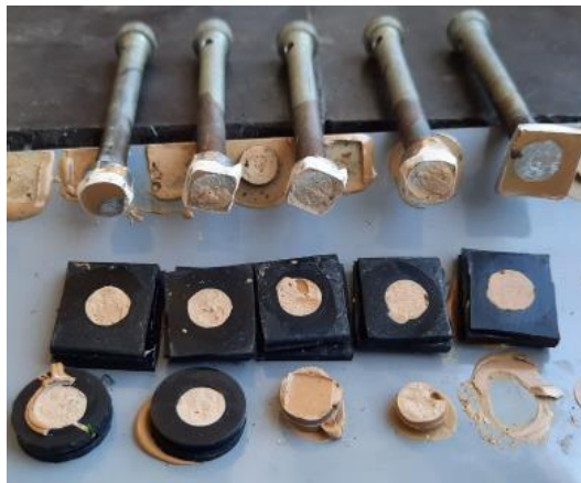
Рис. 4. Когезионное и смешанное разрушение соединения при толщине клеяного слоя 6 мм
