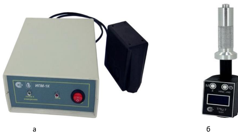
Рис. 1. Экспериментальное оборудование для определения параметров вязкоупругости методом ДКИ: а) прибор ИПМ–1К, б) твердомер ТПЦ–7
