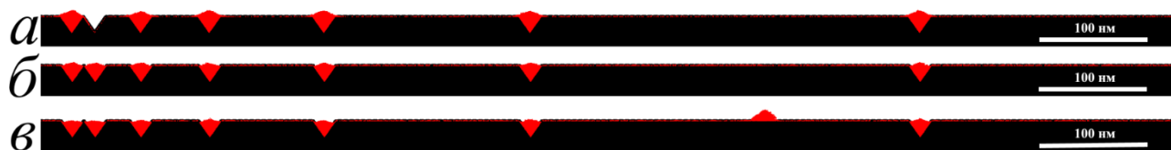
Рис. 4. Морфология массивов капель In, полученных на структурированной поверхности в результате моделирования при различных температурах: а) 250 °С, б) 200 °С, в) 150 °С
