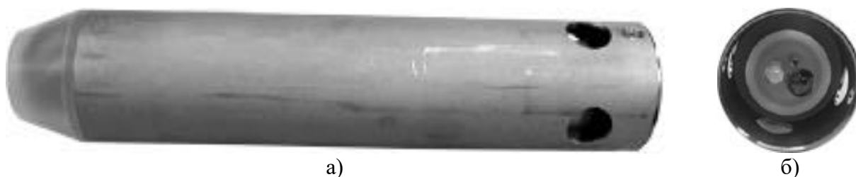
Рис. 3 Общий вид отечественного внутрижелудочного болюса для радиочастотной идентификации КРС (действующий прототип)
