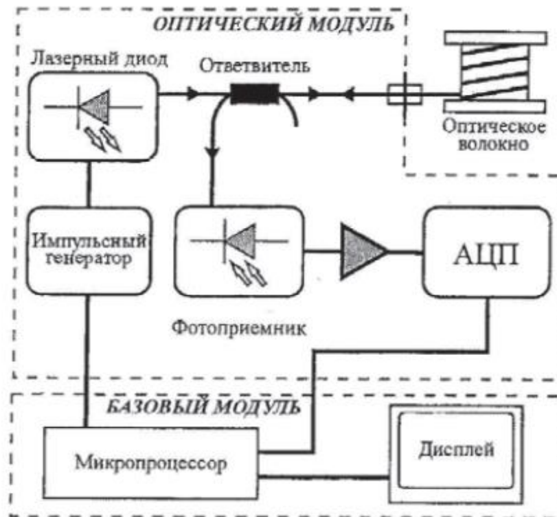
Рис. 2. Блок-схема импульсного оптического рефлектометра
