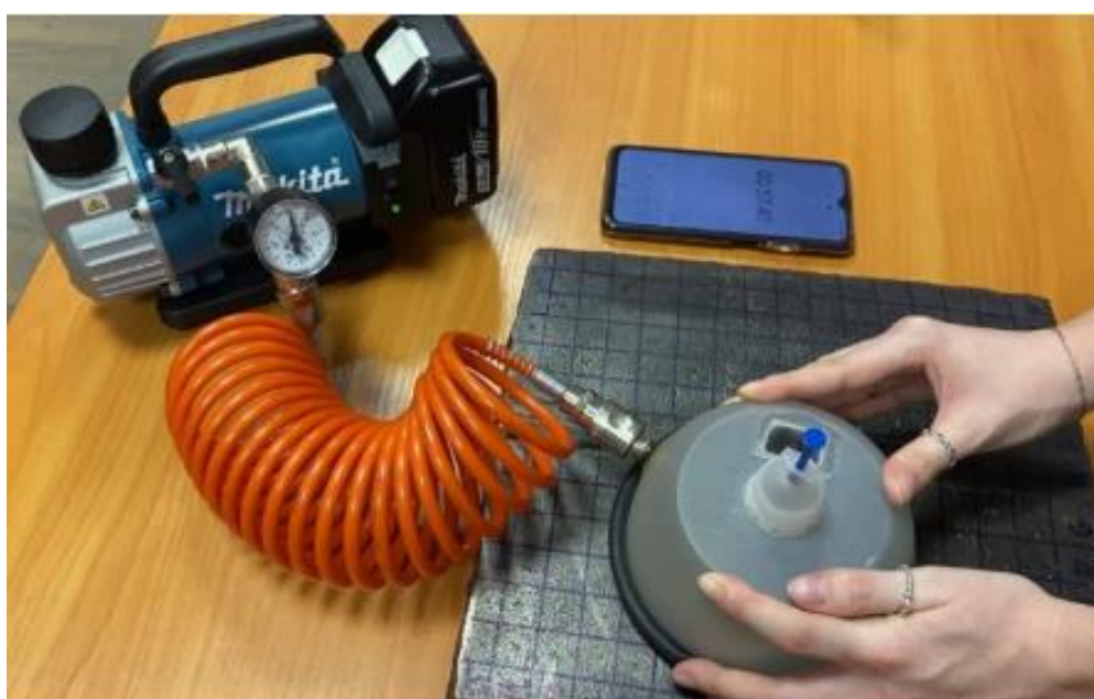
Рис. 2. Внедрение композиционного материала в полость трещины под действием вакуума
