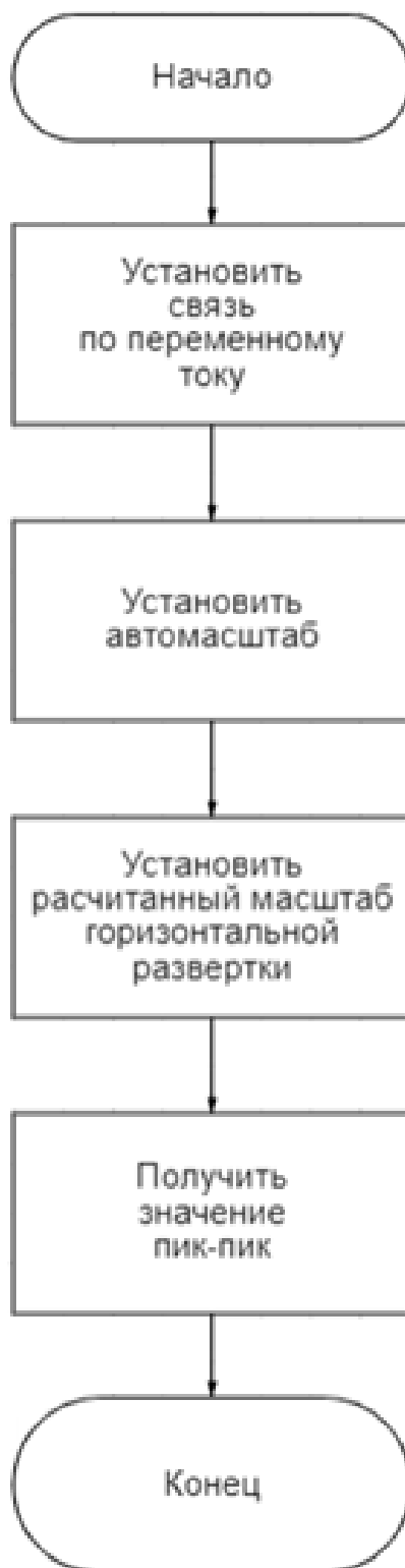
Рис. 2. Блок-схема алгоритма автоматического измерения пульсаций напряжения ППН
