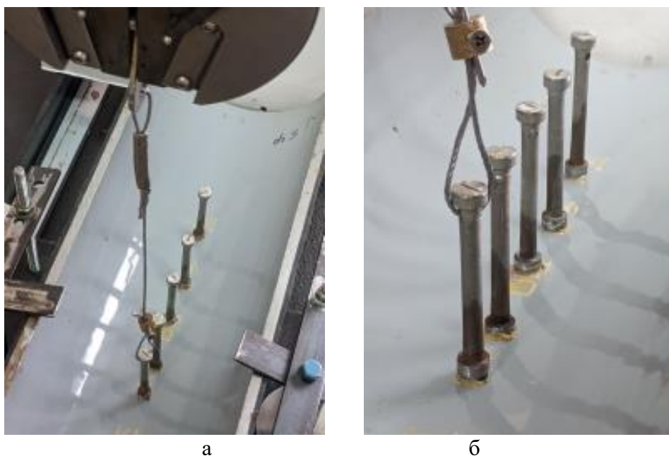
Рис. 1. Закрепление фрагмента трубы на нижнем захвате машины (а) и приложение нагрузки к приклеенному штифту через гибкую связь (б)
