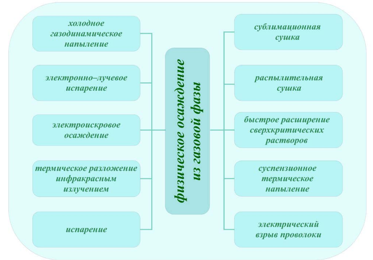
Рис. 4.6. Методы физического осаждения из газовой фазы, используемые для синтеза наноматериалов
