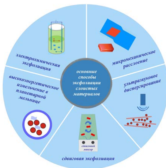
Рис. 6.1. Наиболее распространенные способы эксфолиации малослойных и однослойных наноматериалов [44]
