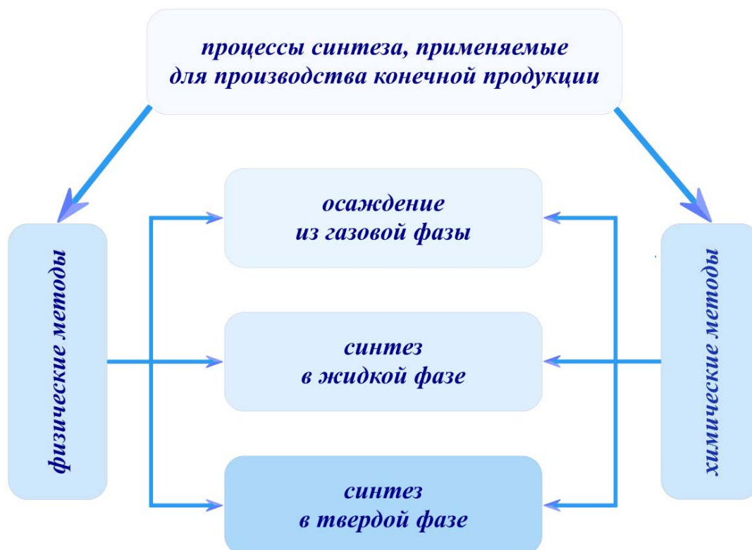
Рис. 4.5. Методология классификации процессов синтеза наноматериалов в зависимости от агрегатного состояния фазы и характера процесса [31]
