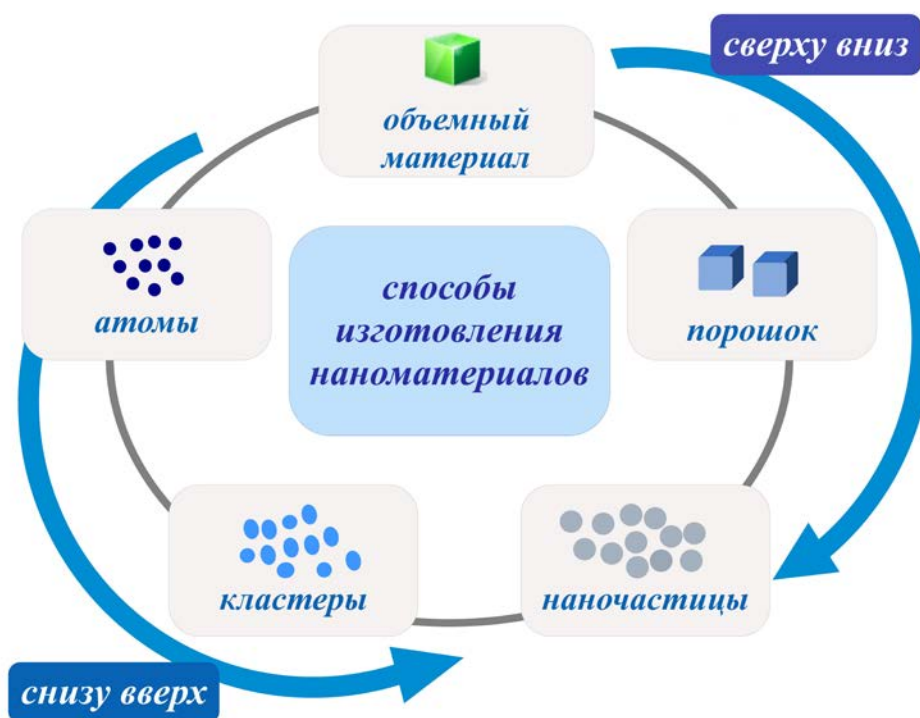
Рис. 4.3. Концептуальная схема способов изготовления наноматериалов по принципу «сверху вниз» и «снизу вверх» [17]
