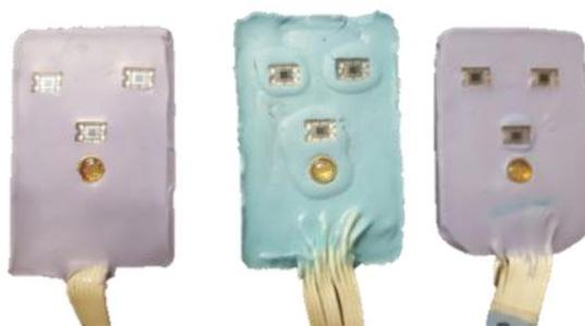
Рис. 4. Зонды церебрального оксиметра на Arduino Due
