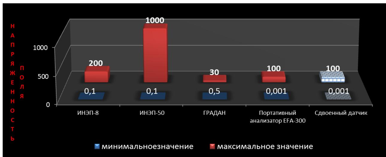
Рис. 1. Диапазон измерения напряженности ЭП
