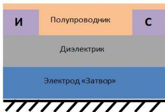
Рис. 3. Архитектура ОПТ с нижним «затвором» и нижними электродами «сток» и «исток»
