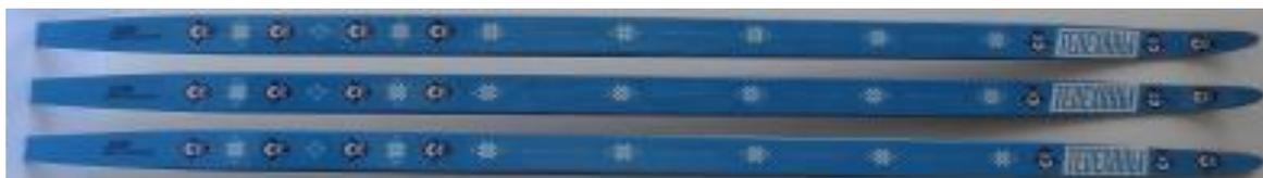
Рис. 1. Образцы лыж для испытаний на изгиб
