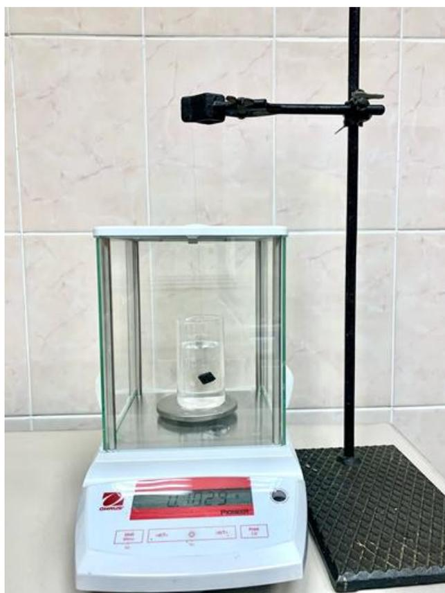
Рис. 4. Установка для метода гидростатического взвешивания
