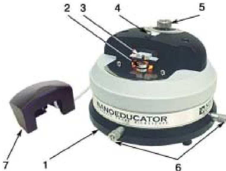
Рис. 1.5. Внешний вид измерительной головки NanoEducator: 1 – основание; 2 – держатель образца; 3 – датчик взаимодействия; 4 – винт фиксации датчика; 5 – винт ручного подвода; 6 – винты перемещения сканера с образцом; 7 – крышка с видеокамерой
