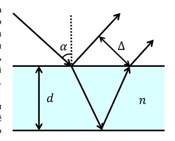
б) максимальное расстояние между лучами  $\Delta_{max}$  для пластинки толщины d и показателем преломления n=1,25.
