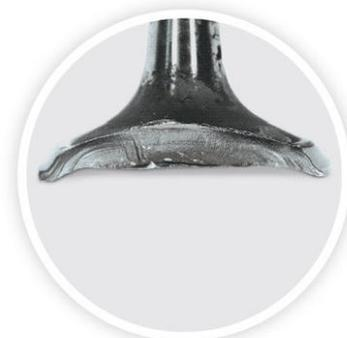
*Рис. 12.* Прогиб головки клапана
