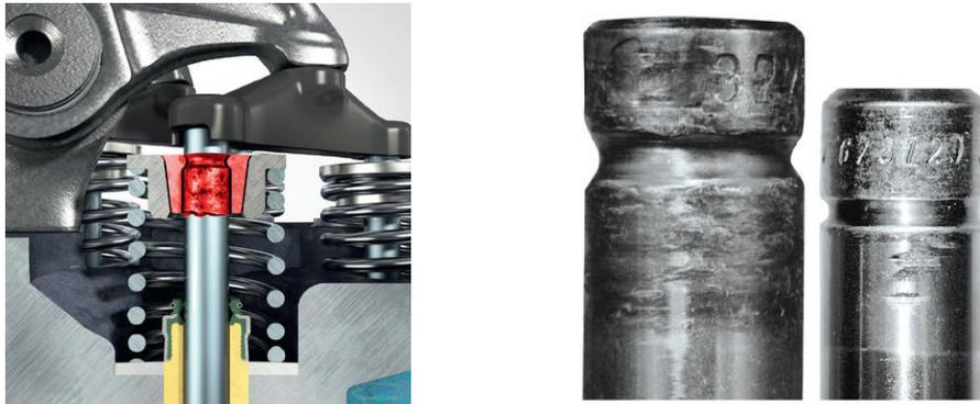
*Рис. 9.* Износ сухаря клапана
