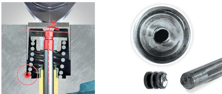
Рис. 4. Ошибка при монтаже пружины клапана
