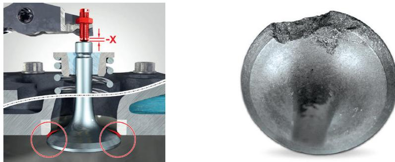
Рис. 3. Неверная регулировка зазора в клапане
