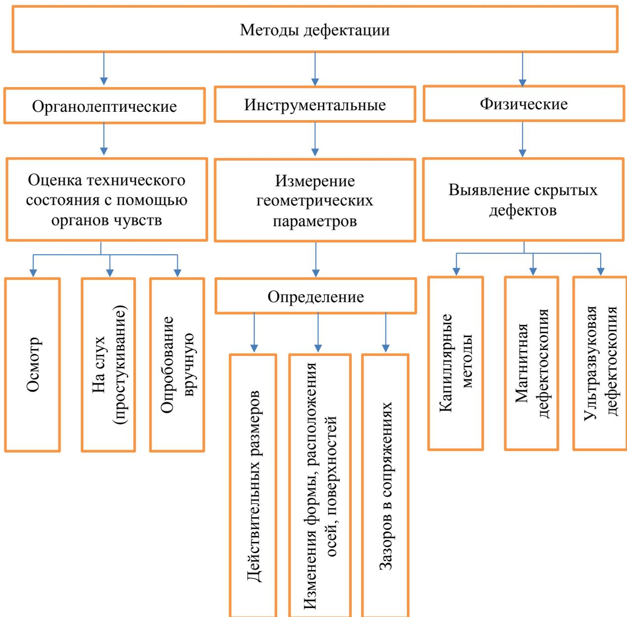
Рис. 16. Классификация методов дефектации
