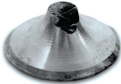
*Рис. 11.* Изгиб головки клапана
