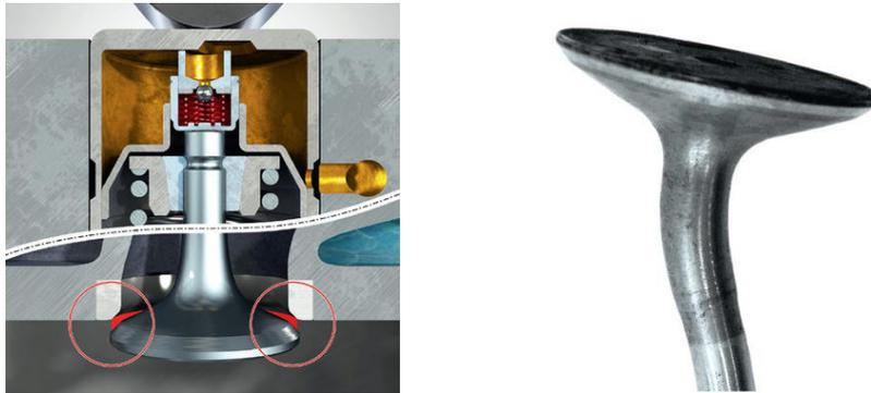
Рис. 5. Ошибка при монтаже гидротолкателя
