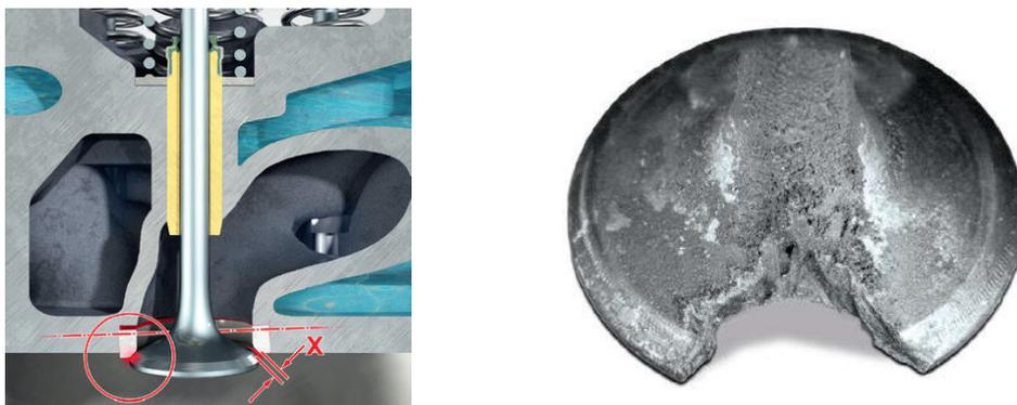
Рис. 6. Ошибка соосности направляющей или кольца седла клапана
