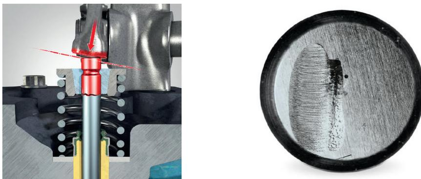
*Рис. 10.* Односторонний износ стержня
