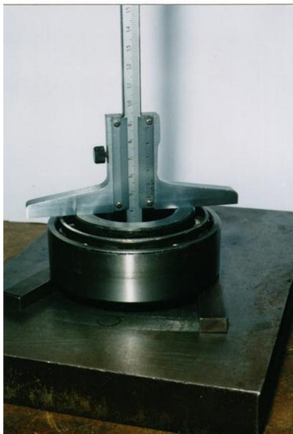
*Рис. 16.* Контроль монтажной высоты при помощи штангенглубиномера
