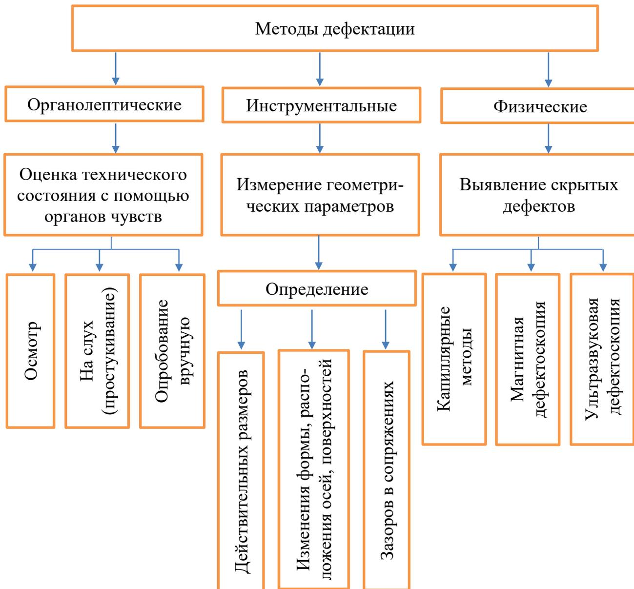
Рис. 14. Классификация методов дефектации
