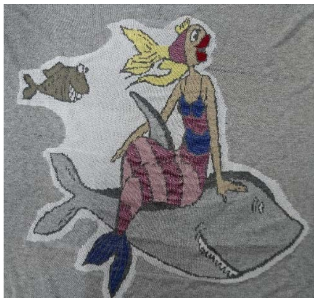
Рис. 1. Интарсионный жаккард с использованием 14 интарсионных нитеводов.
