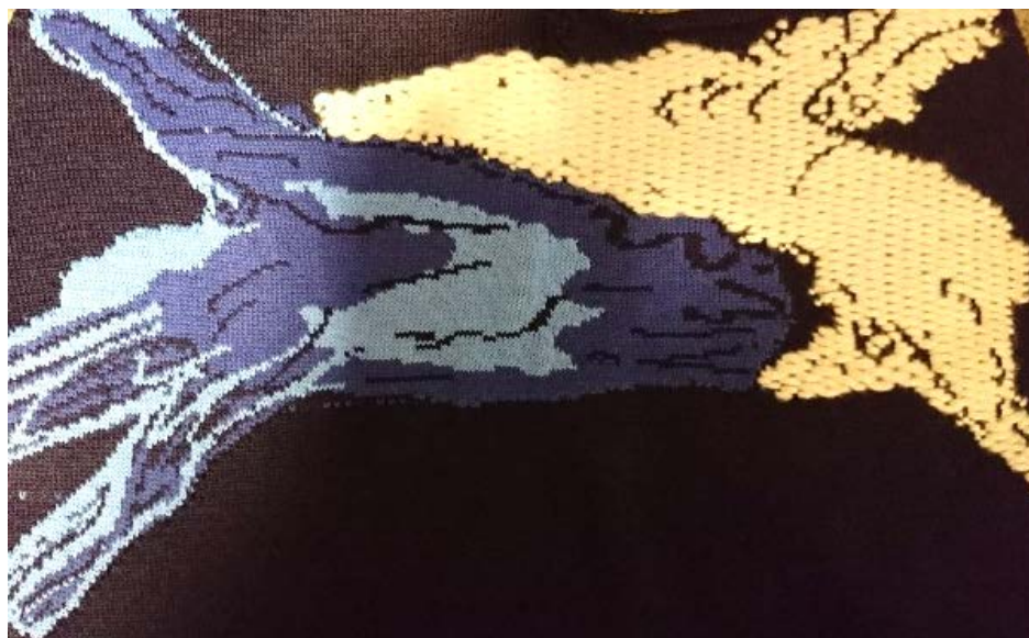
Рис. 2. Интарсионный жаккард с уточными протяжками
