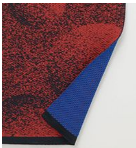
Рис. 4. Однофантурное платированное переплетение
