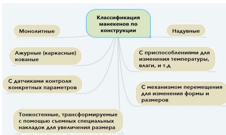
Рис.4. Классификация манекенов по конструкции
