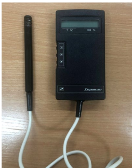
Рис. 2. Термогигрометр ИТ 5-ТР «Термит»
