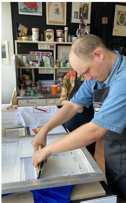
Рис. 2. Печать «подтягивание ракеля на себя»
