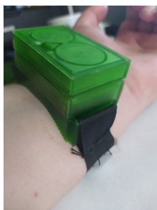
Рис. 2. Устройство для контроля и мониторинга жизненно важных показателей организма ЛОДВ:
