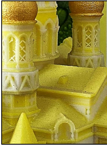
Рис. 1. Фрагмент архитектурного макета, выполненного на 3D-принтере Z450
