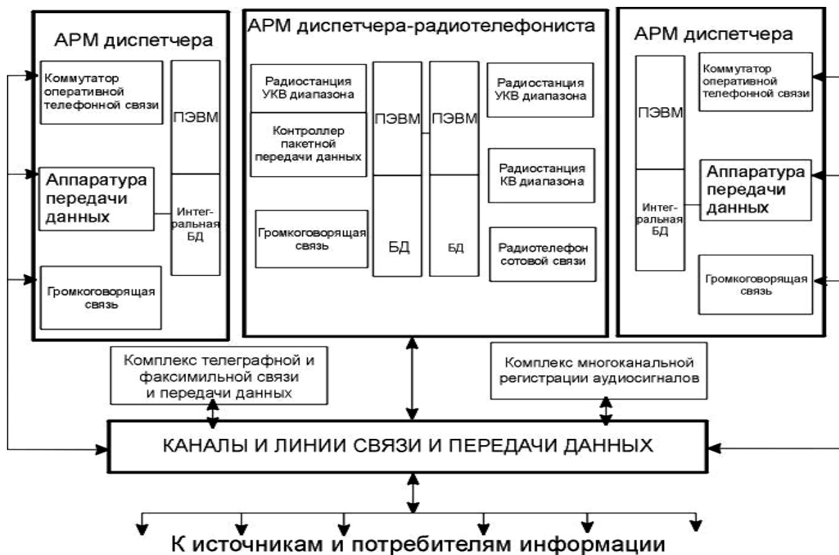
Рис. 7.2. Функциональная схема АСУ
