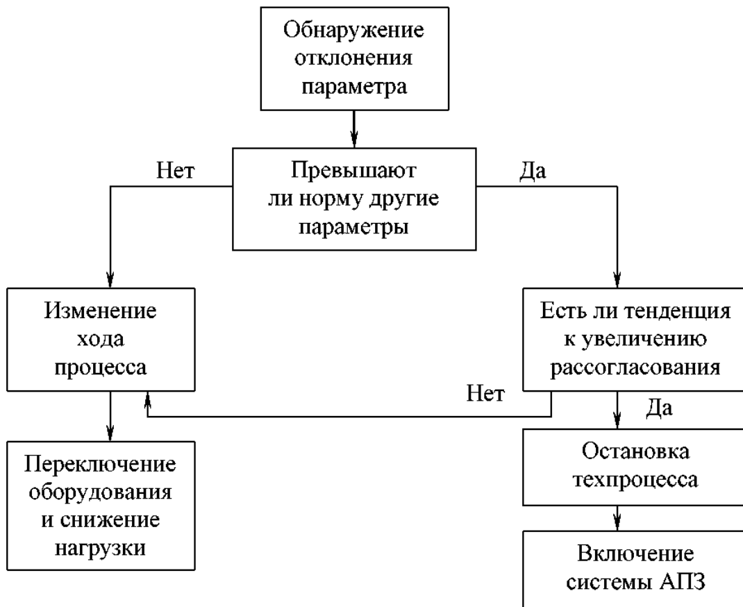
Рис. 66. Блок-схема программы анализа аварийного сигнала
