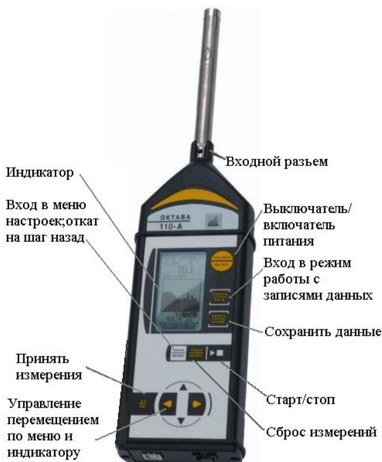
Рисунок 5 – Шумомер-анализатор спектра, виброметр портативный «ОКТАВА-110А»
