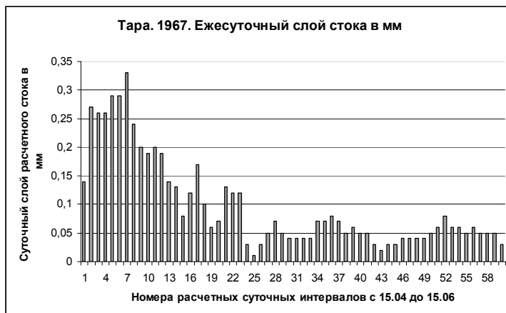
Рис. 1. Расчетный гидрограф элементарного стока, полученный по исходным метеоданным ст. Тара для маловодного 1967 г. Ось ординат — суточные слои стока в мм
