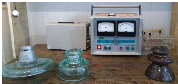
Рис. 4. Испытуемые изоляторы ПС70Е, ШС10Е и ШФ10Г (изображены по порядку слева направо)
