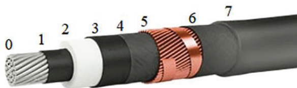
Рис. 2. Строение кабеля АПВП: 0 — алюминиевая жила; 1 — экран по жиле; 2 — изоляция; 3 — экран по изоляции; 4, 6 — кабельная бумага; 5 — медный экран; 7 — оболочка кабеля
