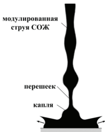
Рис. 2. Регистрация АЭ сигнала и измерение температуры при точении (а) и форма модулированной струи СОЖ при подаче в зону резания с образованием утолщений, перешейков и не оторвавшейся от струи капли (б)
