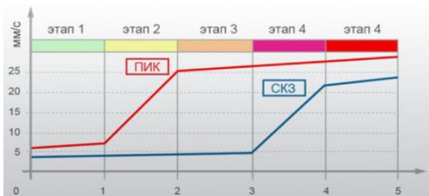
Рис. 1. График зависимости среднеквадратического значения фона и пиковых значений в дефектном подшипнике
