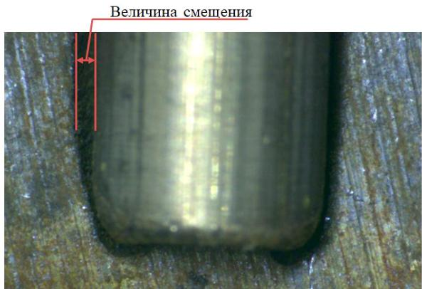
Рис. 3. Образование конусности в глухом отверстии
