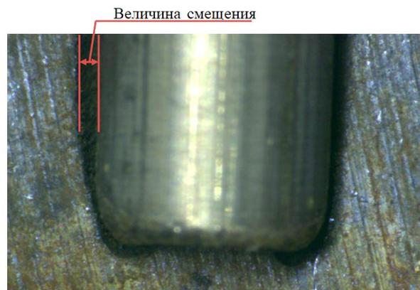
Рис. 3. Образование конусности в глухом отверстии
