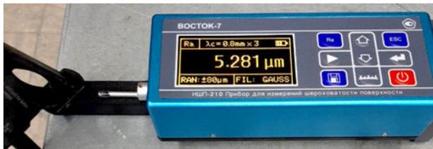
Рис. 12. Измерение шероховатости образца
