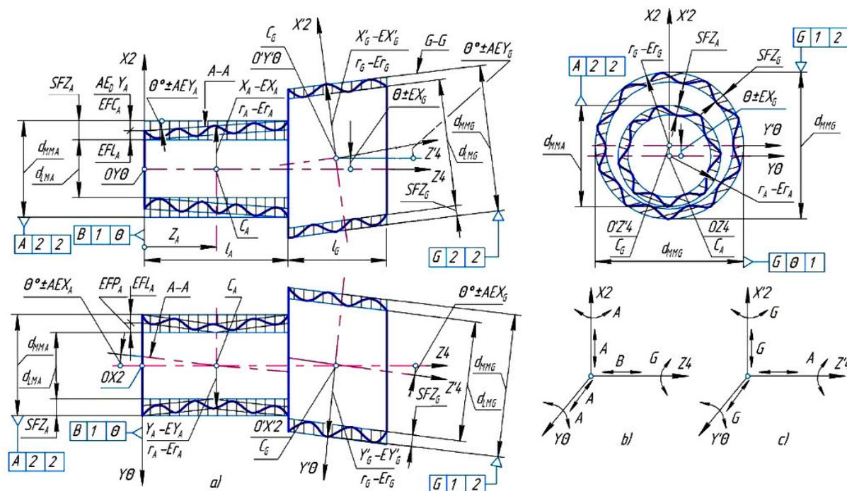
а) -реальные адекватные 2d- модели элементов в трех проекциях; б) и в) - индикаторы информативности баз А4 и G4;  $C_A, C_G$  - центры средних сечений базовых размерных элементов А4 и G4; А-А, G-G - образующие цилиндрических поверхностей базовых размерных элементов А4 и G4;  $r_A, r_G$  - радиусы вращения образующих А-А, G-G в средних сечениях элементов относительно осей Z4 и Z'4; SFZ - суммарные отклонения расположения образующих А-А, G-G и формы поверхностей размерных элементов А4 и G4.
