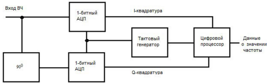
Рис. 1. Структурная схема цифрового измерителя частоты
