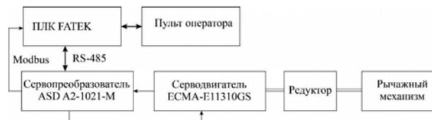
Рис. 6. Структурная схема системы управления приводом подачи
