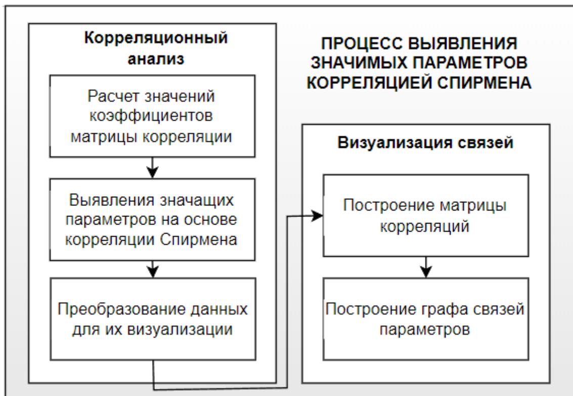
Рисунок 2.5 – Схема процесса выявления значимых параметров корреляционным методом
