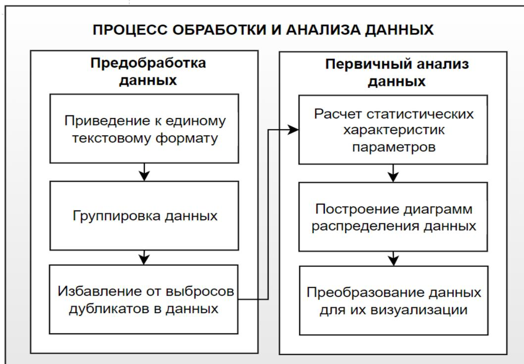
Рисунок 2.1 – Схема процесса обработки и анализа данных
