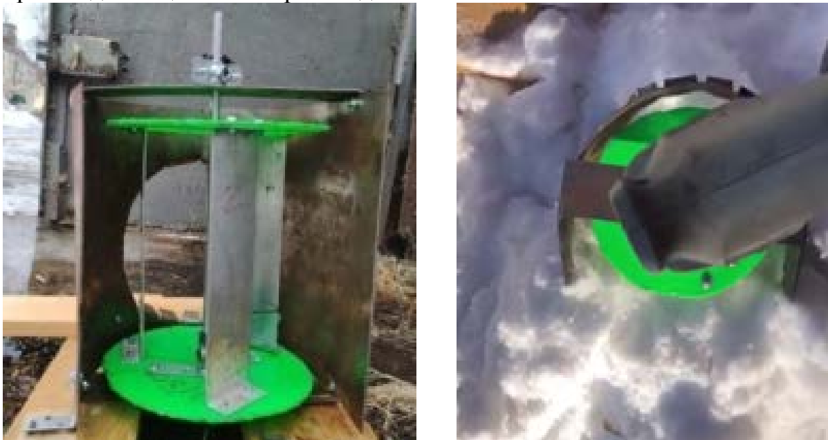
Рисунок 28 – Прототип перспективного рабочего органа РСО: а) общий вид; б) вид сверху в процессе работы
