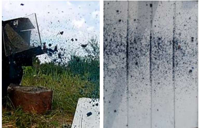
Рисунок 22– Фрагмент экспериментальных исследований работы ротора МА и распределения отброшенной массы: а) МА в процессе работы; б) фрагмент формирования снежного вала
