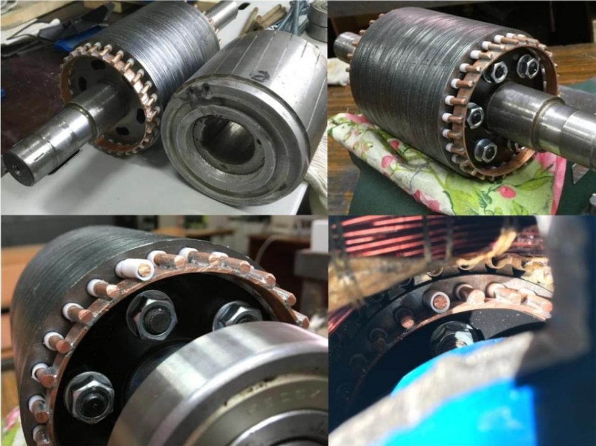
Рис. 5. Готовый экспериментальный ротор с обрывом одного стержня
