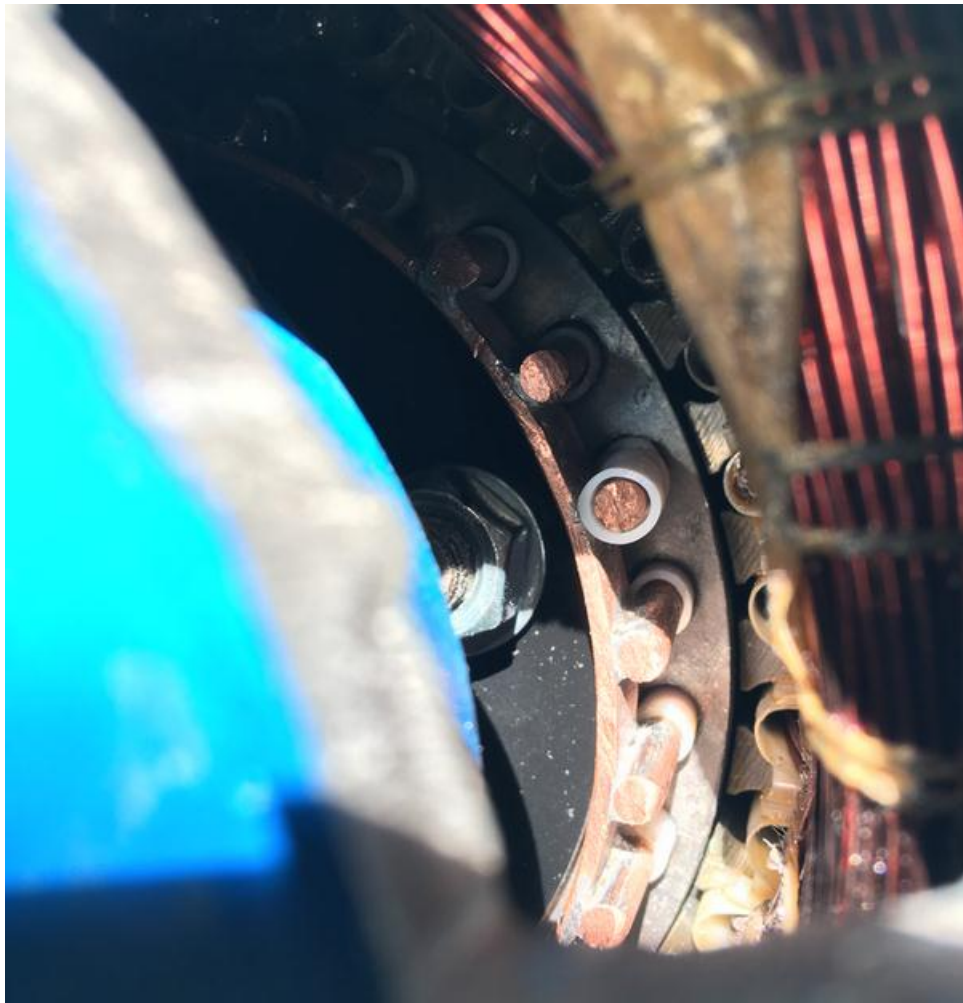
Рис. 4.12. Ротор испытуемого АД с обрывом одного стержня в сборе со статором
