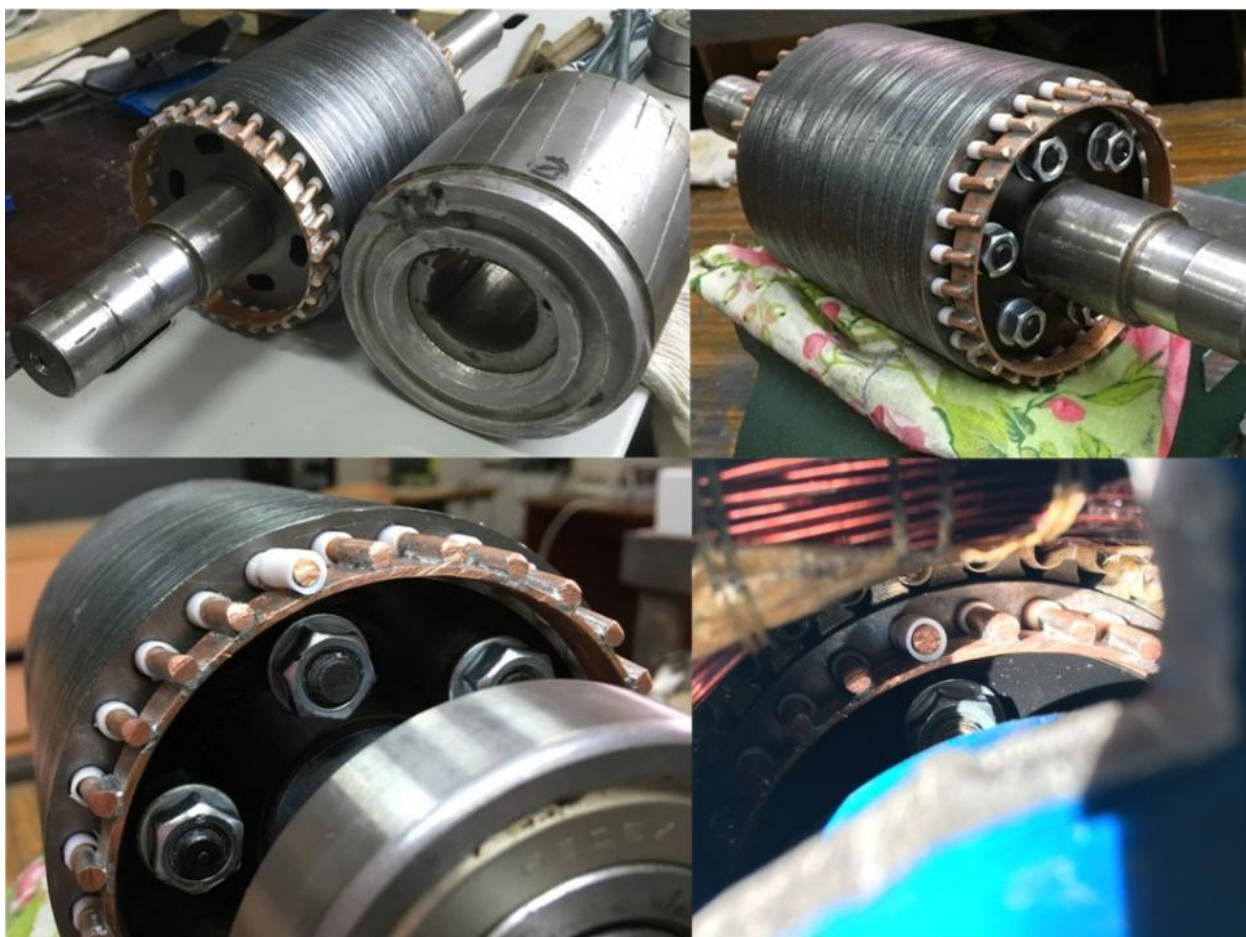
Рис. 3.21. Готовый экспериментальный ротор с обрывом стержня
