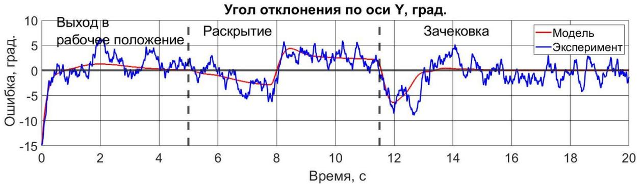
Рисунок 5.7 – Переходные характеристики по углу отклонения по оси Y тросовой системы обезвешивания экспериментальной установки и модели
