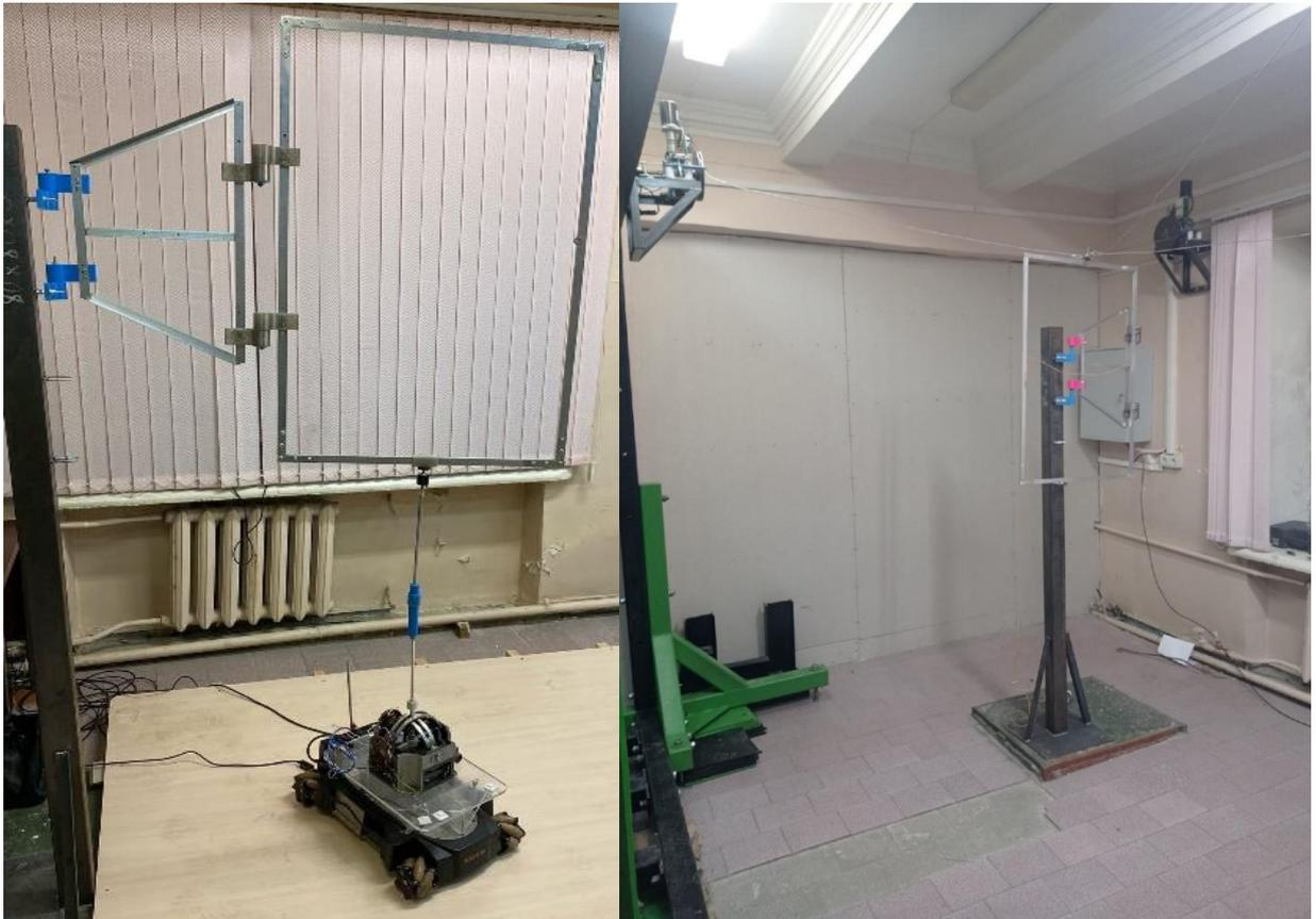
Рисунок 5.1 – Внешний вид лабораторно-исследовательского стенда по опорному и четырехтросовому обезвешиванию солнечной панели.
