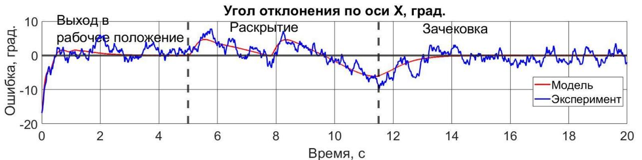
Рисунок 5.6 – Переходные характеристики по углу отклонения по оси X тросовой системы обезвешивания экспериментальной установки и модели
