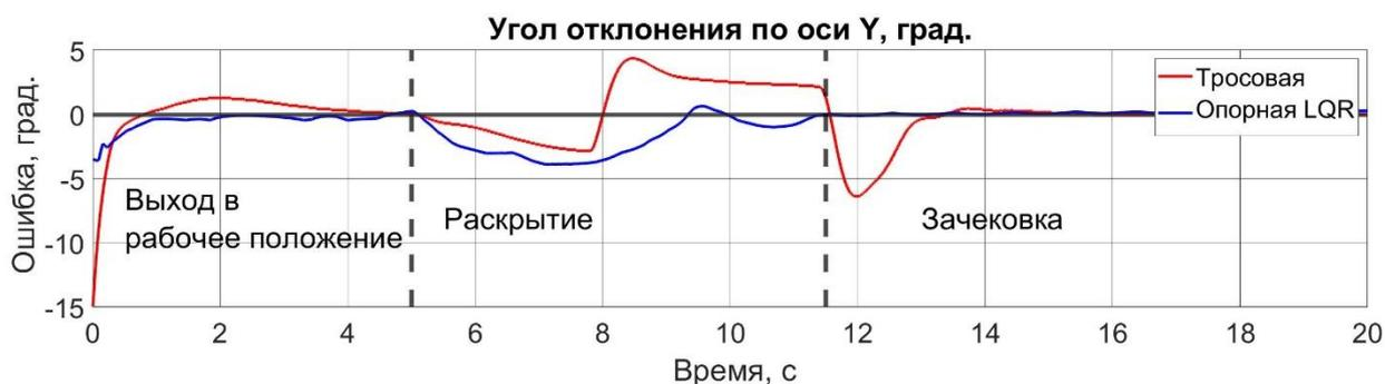
Рисунок 3.20 – Переходные процессы по углу отклонения относительно оси Y
