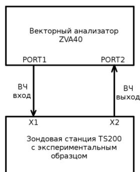
Рисунок 2.16 – Структурная схема измерительной установки для испытания экспериментальных образцов
