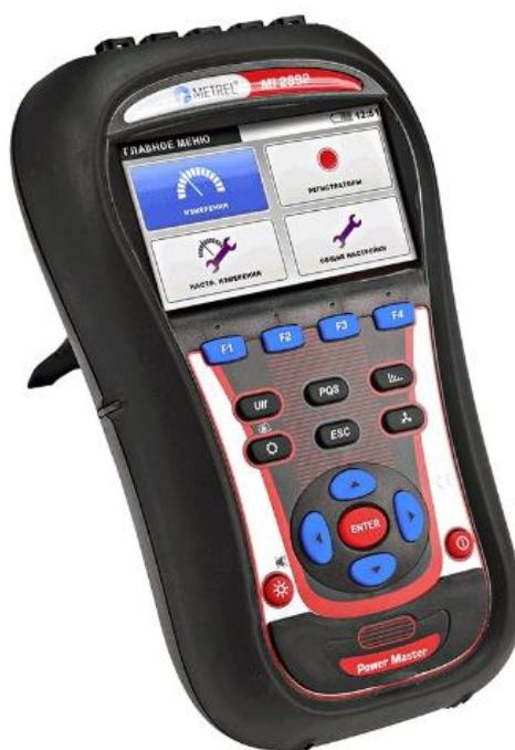
Рисунок 2.12 – Внешний вид специализированного прибора контроля качества электроэнергии класса А МІ 2892
