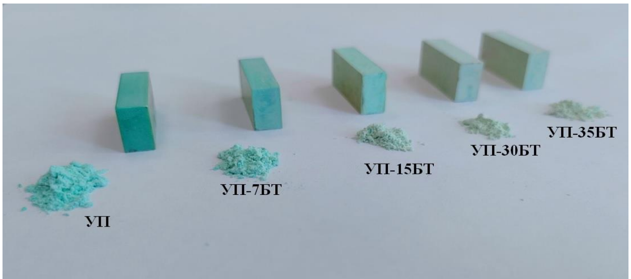
Рисунок 3.5 – Композиции порошков исследуемых составов УП-БТ и пластины, полученные из данных материалов
