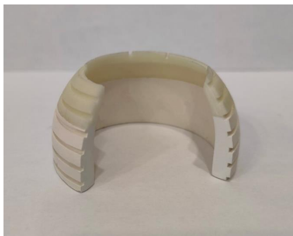
Рисунок 4.19 – Разрез трехслойного корпусного элемента, изготовленного из композиционных материалов на основе низкоплавкой эпоксидно-диановой смолы
