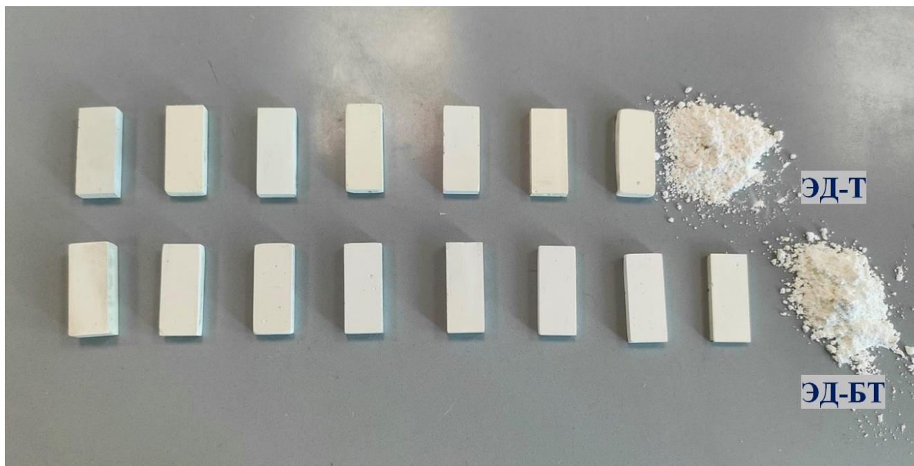
Рисунок 3.9 – Образцы, полученные из материалов типа ЭД-Т и ЭД-БТ и порошки диоксида титана и титаната бария (верхний ряд – 7 образцов исследуемых составов типа ЭД-Т и порошок диоксида титана; нижний ряд – 8 образцов исследуемых составов типа ЭД-БТ и порошок титаната бария)
