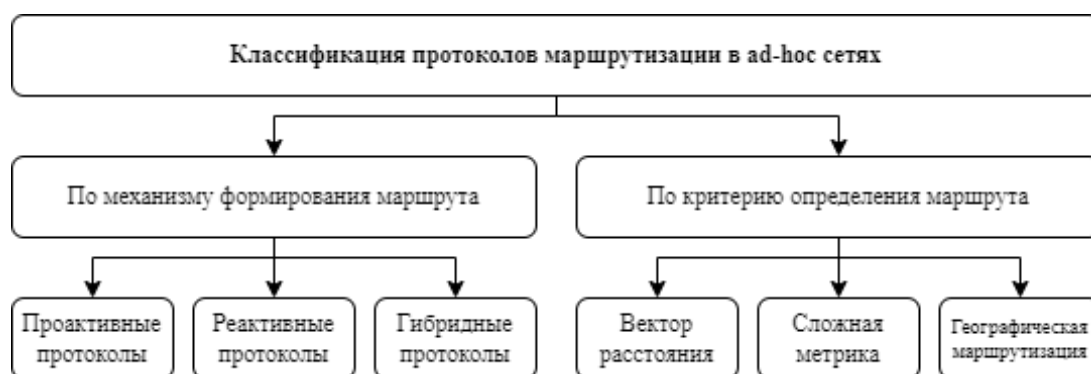
Рисунок 1. Классификация протоколов маршрутизации
