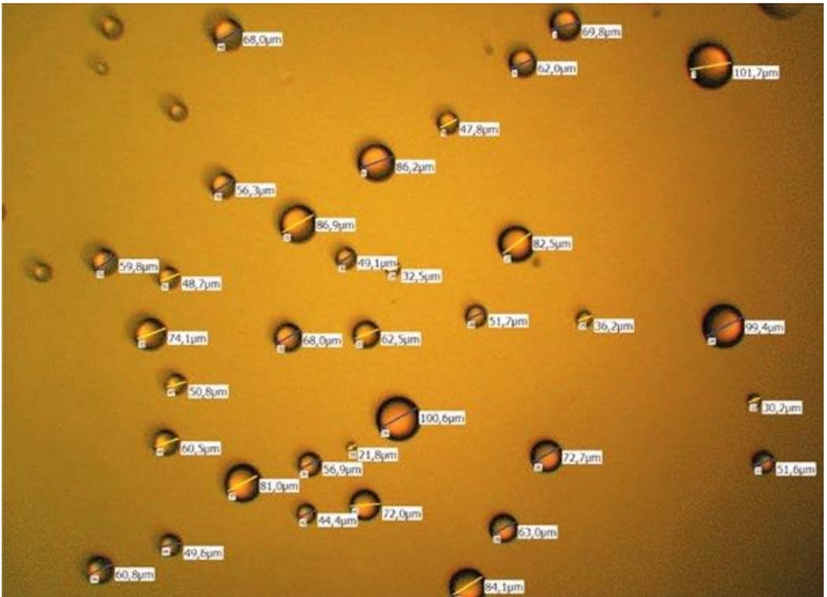
Рисунок 3.7 – Капли масла на ПАВ. Снимок выполнен под микроскопом с цифровой камерой
