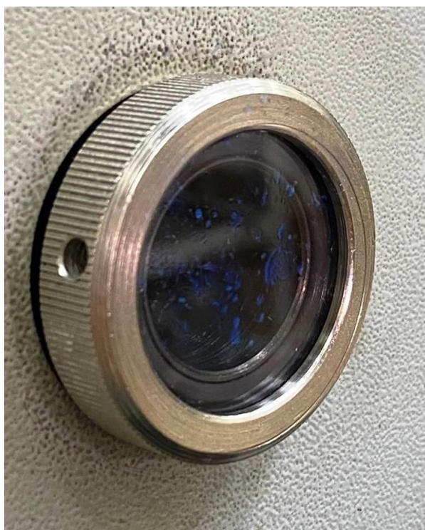
Рисунок 3.16 – Защитное стекло входной линзы полихроматора загрязнённое каплями золя масла TN-400
