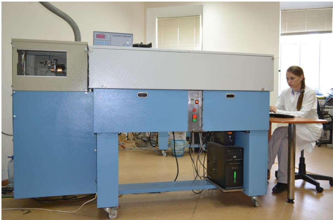
Рисунок 1.5 – СВЧ плазменный анализатор САМ-ДТ-01-2
