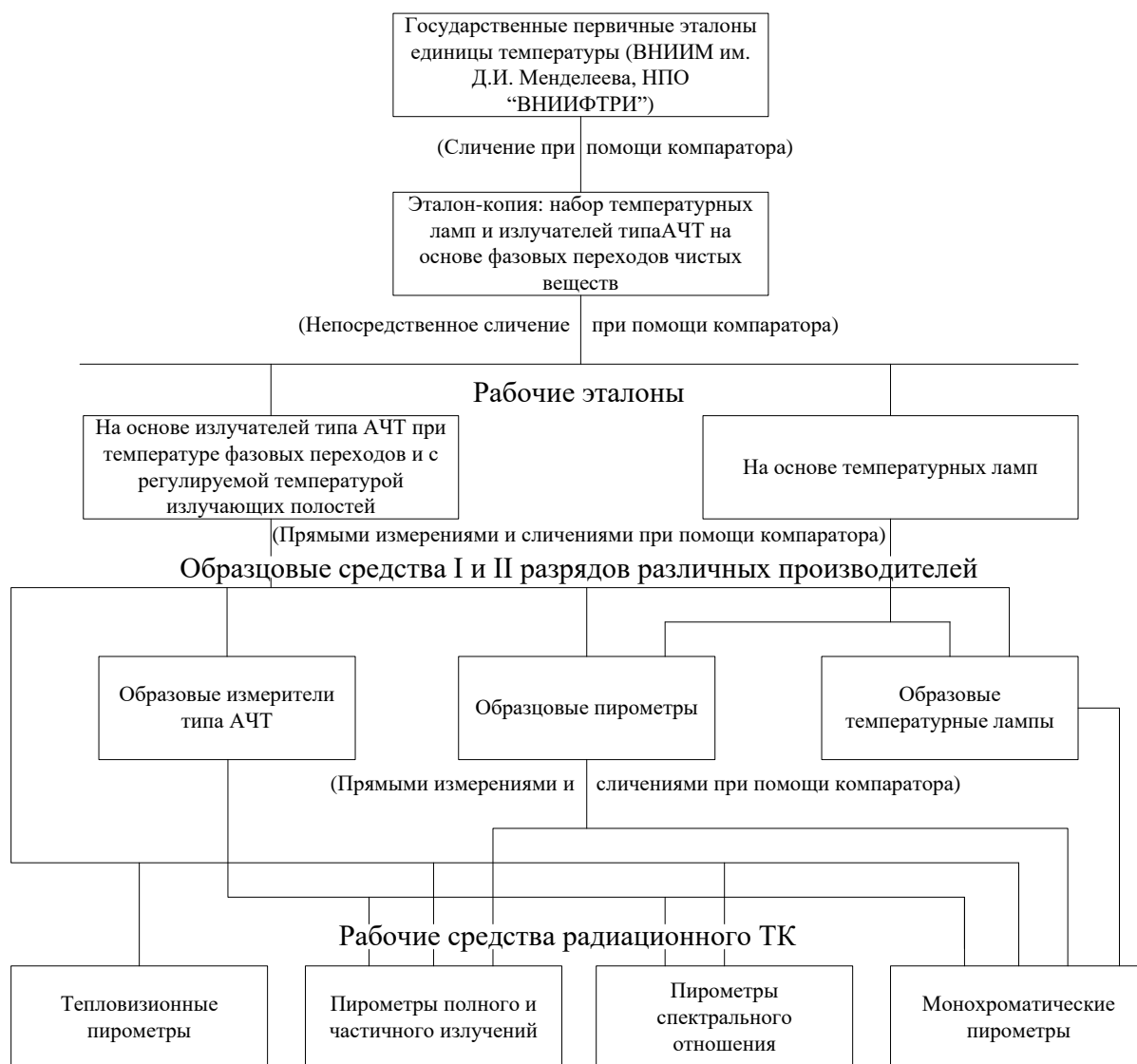
Рис. 1.3. Обобщенная схема поверки и калибровки пирометров
