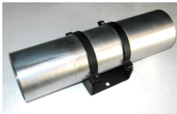
Рис. 2. Пирометр диафрагменного типа для контроля температуры асфальта
