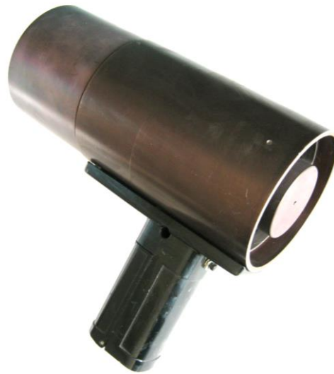
Рис. 1. Пирометр с оптической системой по схеме Кассегрена для контроля качества контактов
