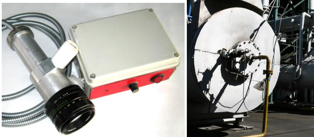
Рис. 3. Пирометр спектрального отношения и его установка на реакторе производства технического углерода
