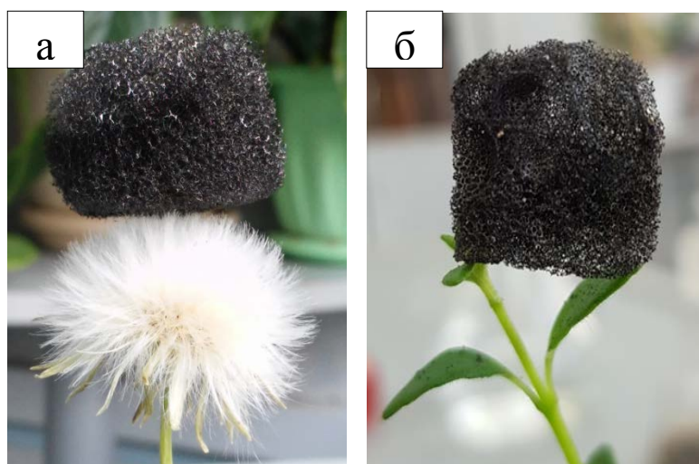
Рисунок 4.7. Ячеистый пеноуглерод, полученный на основе: (а)- жидких продуктов пиролиза пропан-бутановой смеси, (б)- смеси: среднетемпературный каменноугольный пек и пиролизная смола в соотношении 80/20.
