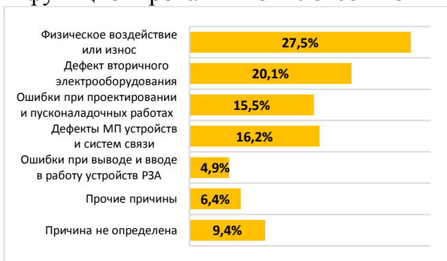
Рис. 3 – Технические причины неправильной работы комплексов РЗА
