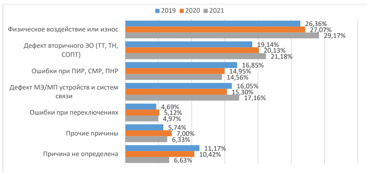
Рисунок 1.3 – Технические причины неправильного функционирования электротехнических комплексов РЗА
