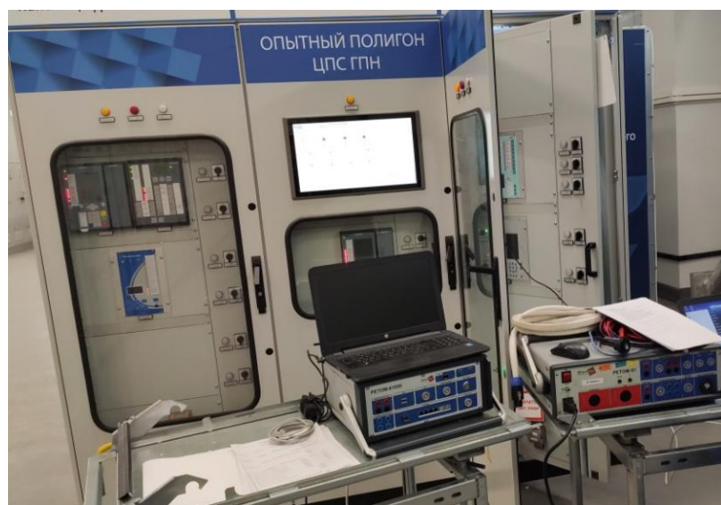
Рисунок 2.12 – рабочее место для проверки параметров комплекса РЗА ЦПС
