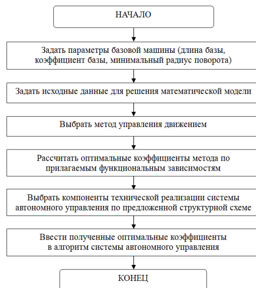
Рисунок 45 – Алгоритм инженерной методики создания системы автономного управления дорожно-строительной машины
