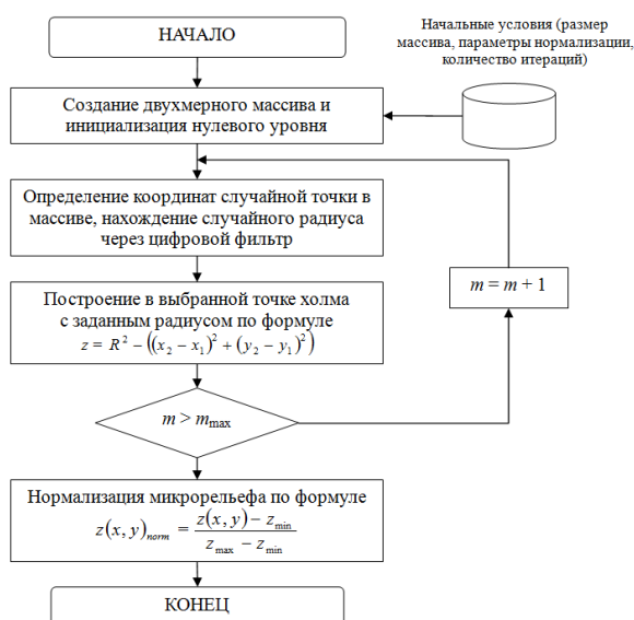
Рисунок 11 – Блок-схема работы программного модуля для моделирования трехмерного микрорельефа
