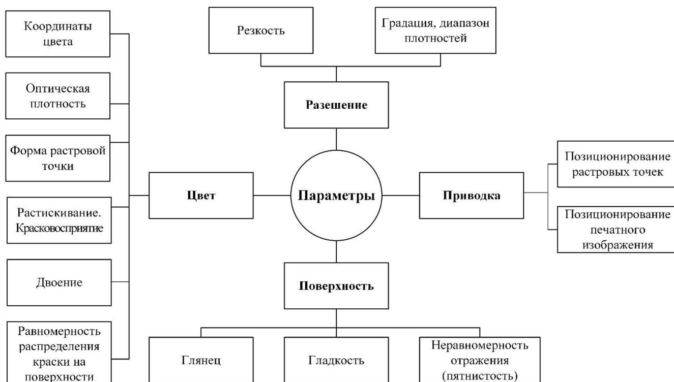
Рисунок 1.2 – Параметры, определяющие качество печатных изделий
