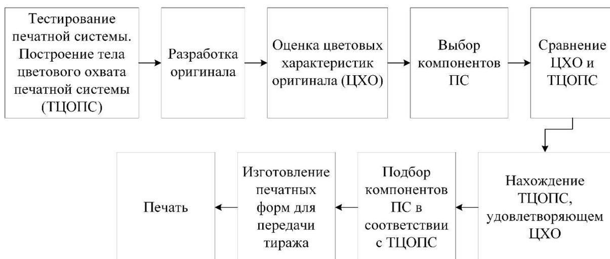
Рисунок 2.6 – Блок-схема процесса для достижения оптимальной цветопередачи [95]
